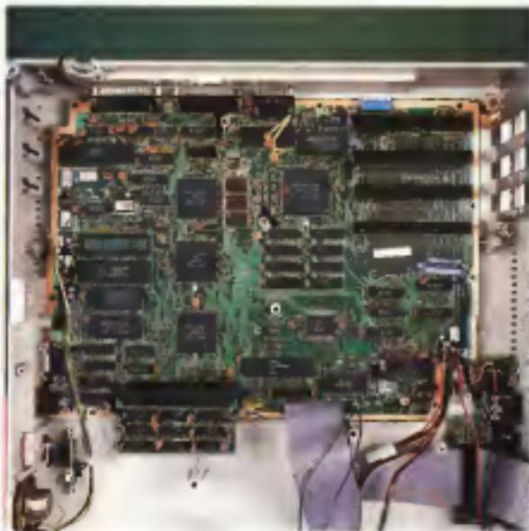
Una bella vista della scheda e floppy memory. In alto a sinistra si vede il controller video VGA, quello a destra la VGA di base si vede le schede con la RAM e sulla sinistra il microprocessore e la ROM del BIOS.
